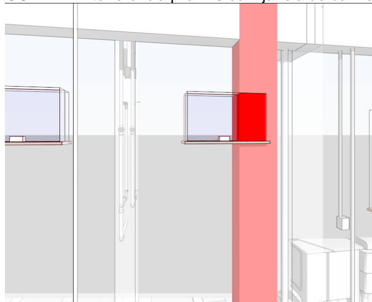
FIGURA 1 - Interferência pilar P5 com janela do banheiro
