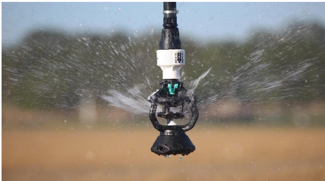
Figura 2- Foto de sprinkler que compõe o pivô central
