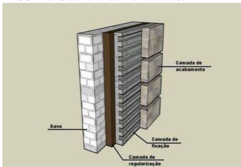
FIGURA 6: Sistema revestimento fachada
