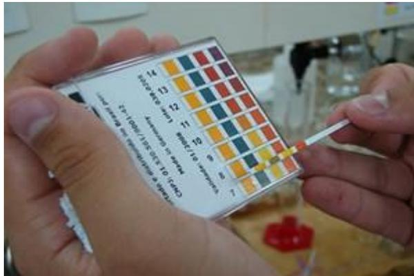
**Figura 1.** Análise de pH através de método colorimétrico. Fonte: Autora (2018).
